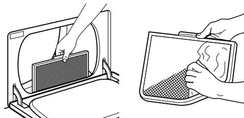
2. Remettre le filtre à charpie en le poussant fermement en place.
